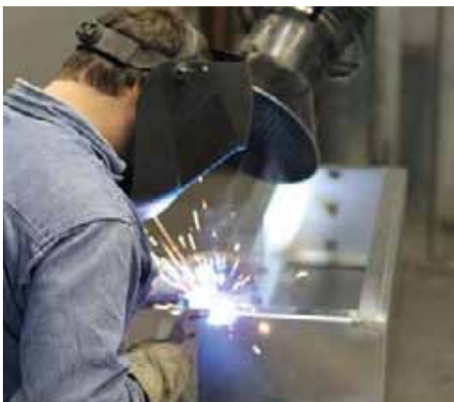
Fabrication d'un capot d'insonorisation en tôle dans notre site de production à Sarrebruck
