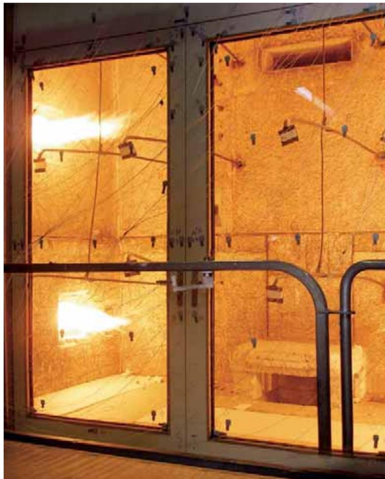
Par des essais d'incendie, nous testons la durée de résistance au feu de nos produits, p. ex. selon la norme DIN EN 1634-1.
