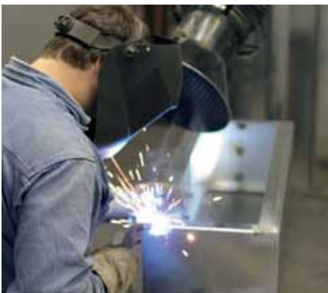
Fertigung einer Blech-Schallschutzhaube in unserer Produktion in Saarbrücken
