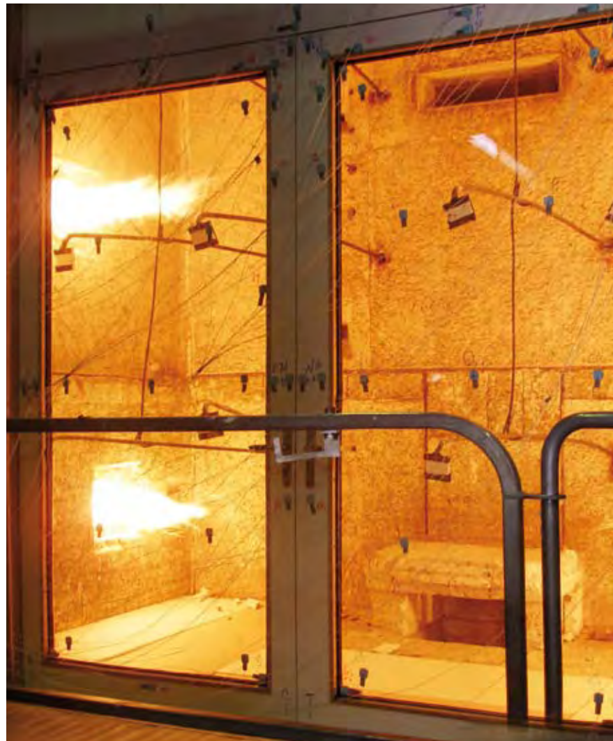
Prüfung des Brandverhaltens nach DIN EN 1634-1.
