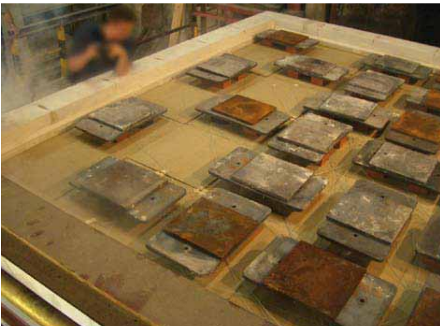
Feuerwiderstandsprüfung eines belasteten Systembodens nach DIN 4102/2.
