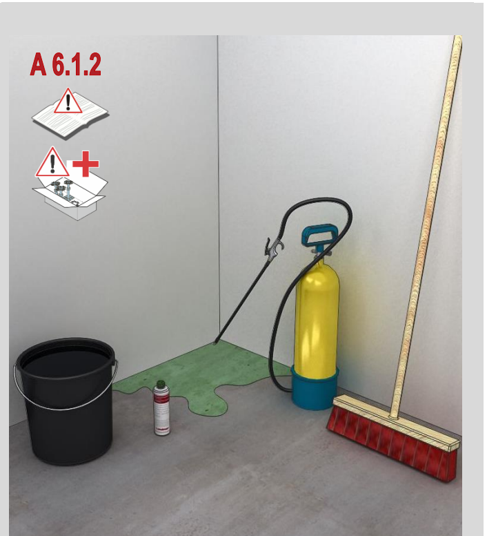
Abbildung 5 Aufbringen der Rohbodenversiegelung
