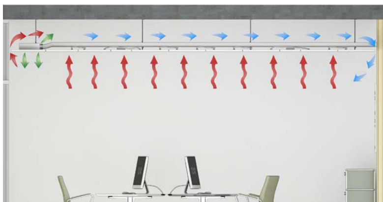
Funktionsweise Plafotherm® B/E AirHybrid
