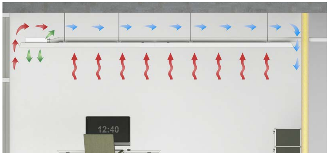
Funktionsweise Plafotherm® DS AirHybrid
