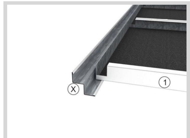
Деталь – потолочная панель тип 1
