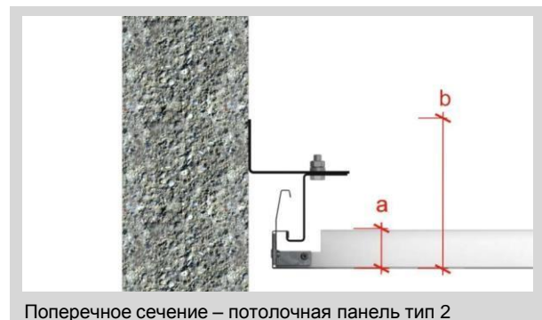
Поперечное сечение – потолочная панель тип 2
